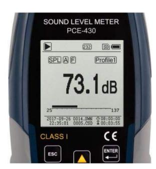
Fonometro con kit per misure in esterno / 1ª classe / Bande di ottava per l'analisi della frequenza (terzi di ottava opzionali) /
